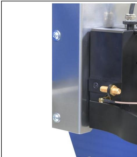
Bild 89: Kabel SSMB-SSMB zur Kollisionskontrolle angeschlossen am Anschlussstecker der Dreheinheit
