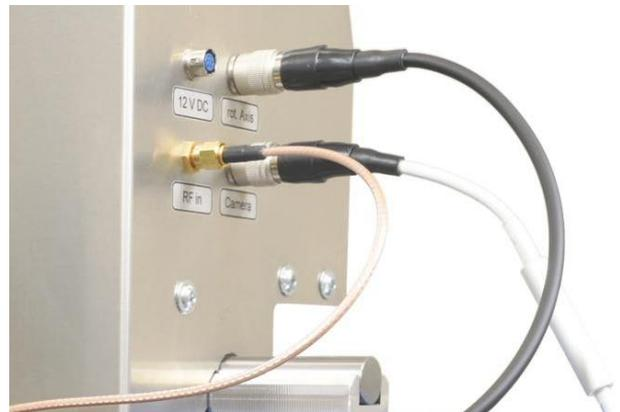
Bild 99: Kabel SMA-SMA RA am Anschluss „RF in“ am Z-Achsenturm
