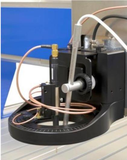
Bild 96: Anschluss des HF-Messkabels an der Nahfeldsonde
