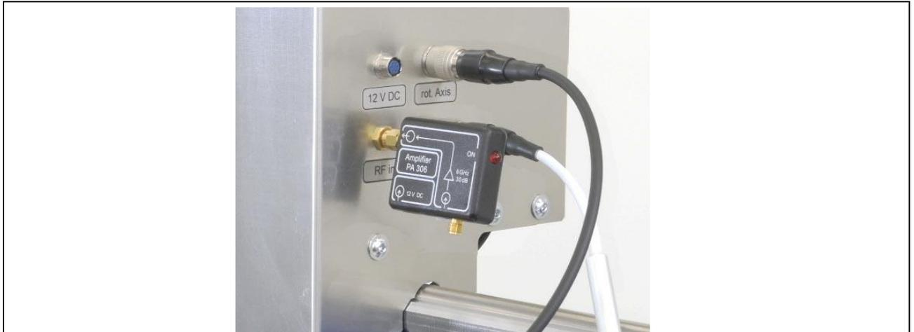
Bild 109: Vorverstärker am „RF in“-Eingang des Scanners
