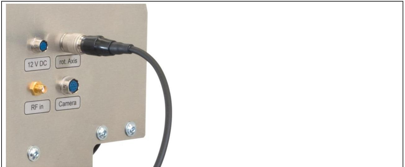
Bild 40: Kabel der Dreheinheit am Anschluss „rot. Axis“
