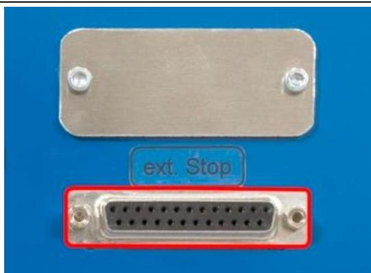
Bild 38: D-Sub-Buchse (ext. Stop)
