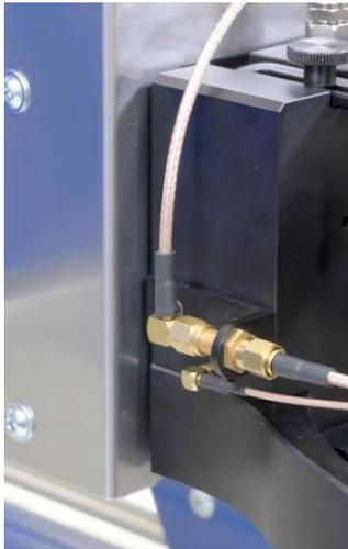
Bild 77: Messkabel SMA-SMA RA an der SMA-Kupplung anschliessen
