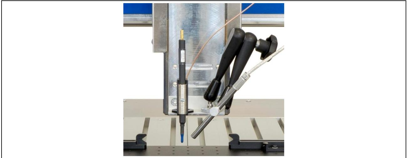
Bild 107: Die Nahfeldsonde wird an der Sondenhalterung befestigt
