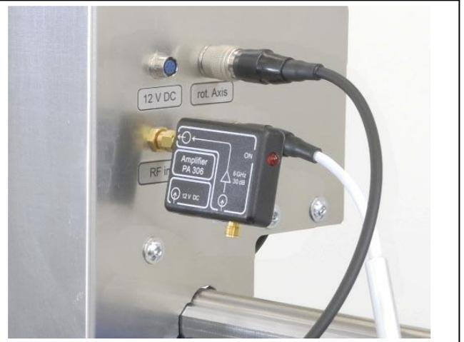
Bild 101: Vorverstärker am „RF in“-Eingang des Scanners
