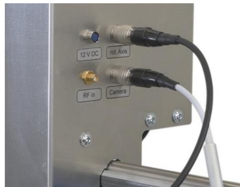
Bild 48: Anbringen des HR10-Steckers der DM-CAM am Anschluss „Camera“ des Z-Achsenturmes
