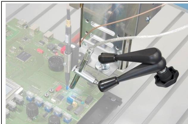
Bild 47: Installierte digitale Mikroskopkamera DM-CAM am Kameraarm KA 220
