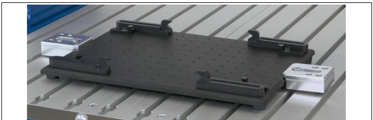
Bild 30: UH DUT mit Krallen claw 01 und claw 02 auf T-Nutenplatte
