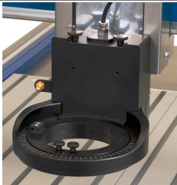
Bild 14: Dreheinheit mit SMA-SMA-Kupplung und Befestigungsschrauben
