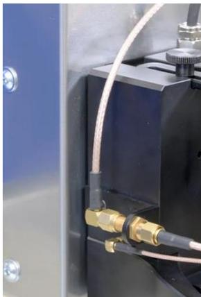
Bild 98: Kabel SMA-SMA RA verbunden mit SMA-Kupplung
