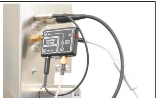
Bild 111: Angeschlossenes Spannungsversorgungskabel
