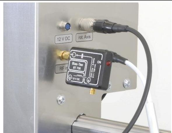
Bild 86: Am Scanner befestigter Bias-Tee („RF in“)
