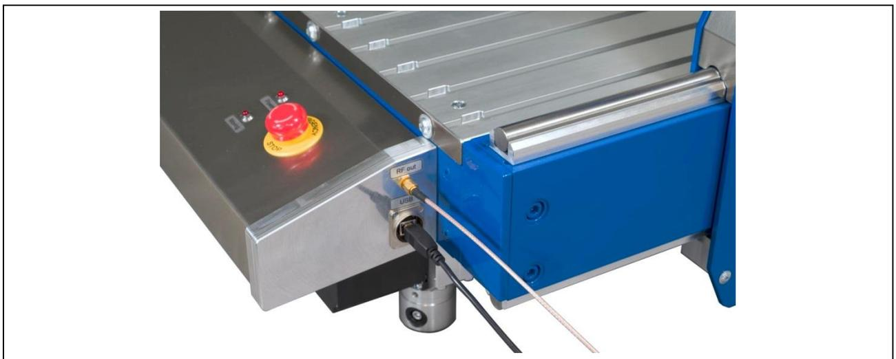
Bild 51: Anschluss des Messkabels mit SMA-Stecker am „RF out“ des Scanners
