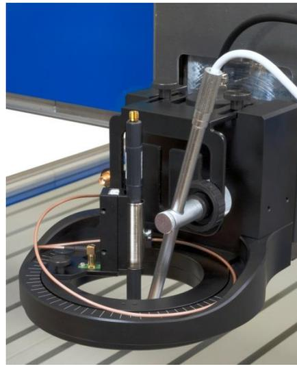
Bild 94: Nahfeldsonde mit Sondenhülse installiert
