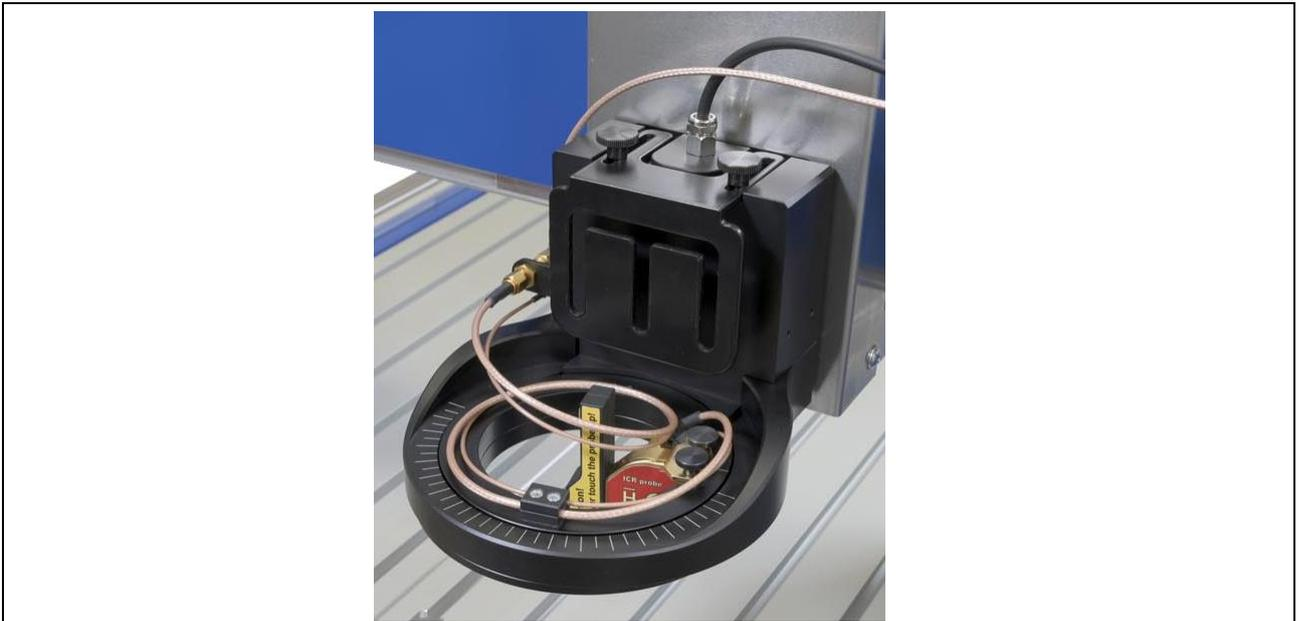
Bild 82: Mit Rändelschrauben befestigte ICR-Sonde
